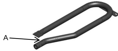
A. Tornillo de ajuste del obturador de aire
