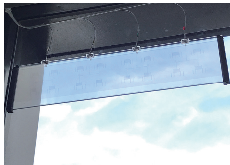
世界初のガラスアンテナを用いた「窓の基地局化」(AGC社提供)
