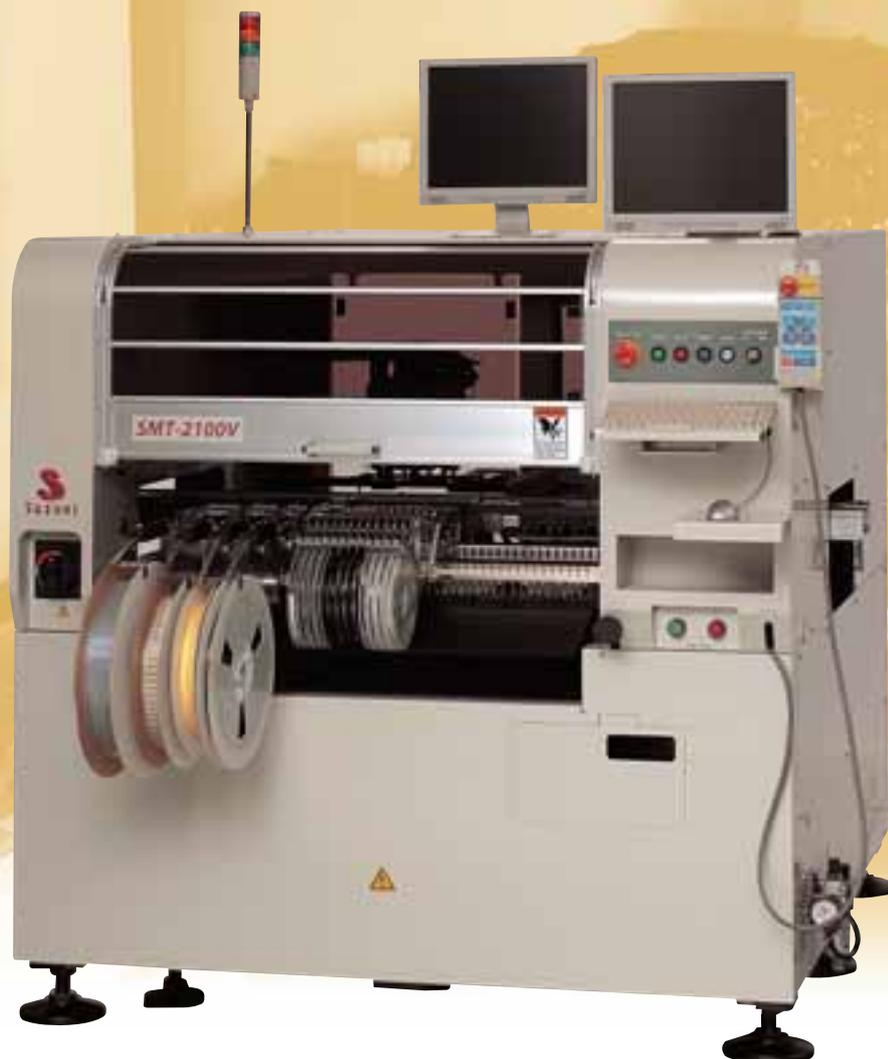
微小チップ部品0603(0201)～大型50×50mmまでの部品とFine-Pitch QFPやBGA、uBGA、CSP、Connector(max 100×50mm)などを搭載できる中型汎用部品実装機です。最適条件で16,300 CPH、実生産において13,500CPH(IPC9850)という高生産性と柔軟性を両立させながらもメンテナンス性をも考慮しました。チップシューターと異形機の機能を兼ね備えたことにより、これ1台で様々な部品を高速・高精度に実装することができ、多品種・少量生産という今日の生産形態を提案いたします。新型ダイレクト駆動独立型ヘッド、高剛性鋳物フレーム、高速画像処理システムは長時間における生産にも安定した部品実装を実現しています。年々複雑化する実装機とは一線を画し、メンテナンス性と扱いやすさにも考慮した扱い易い実装機を1985年弊社実装機1号機から数えて20年の実績と経験がSMT-2100Vを実現しました。
