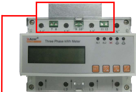
Figuur 8. Vermogensmeter – Connectie 1
