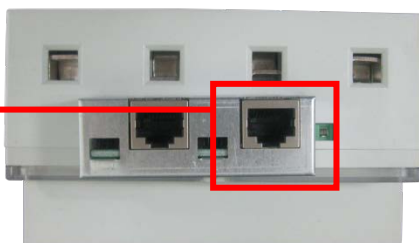
Figuur 9. Vermogensmeter – Connectie 2
