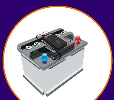
4.- Conecta primero el cable negro del dispositivo al borne negativo de la batería y **después el cable rojo** al borne positivo. Ajusta las tuercas y verifica que quede firme.
