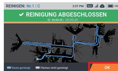
Routen mit abgeschlossener Reinigung werden blau angezeigt und Routen ohne abgeschlossene Reinigung weiß.
