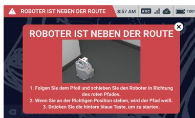
Führen Sie das Gerät auf den Reinigungsweg zurück und drücken Sie die Start-/Stopp-Taste der Autonomen Reinigung.
