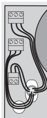
Da im Gehäuse nicht viel Platz zur Verfügung steht, verwenden Sie für den Anschluss ein Telefonkabel mit nicht mehr Adern als notwendig. Der Kabelmantel sollte nur bis kurz hinter der Einföhrung in das Gehäuse reichen. Beachten Sie für eine günstige Verlegung innerhalb des Gehäuses die nebenstehende Abbildung.
