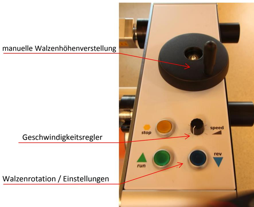
**Walzenrotation** – die untere Walze wird von einem Elektromotor angetrieben. Bei der EcoLam können die Umdrehungen kontinuierlich im Bereich vom 0 bis 4 m/min gesteuert werden.
