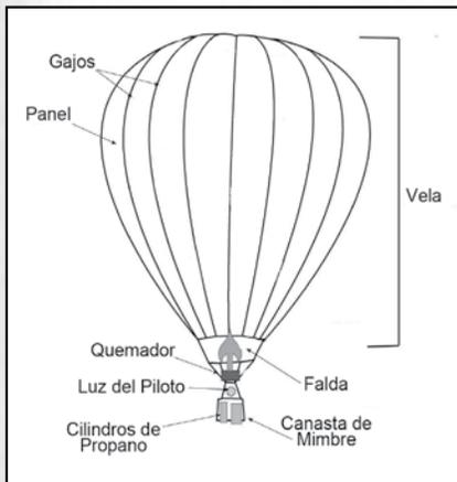
*Diagrama de un globo de aire caliente*
