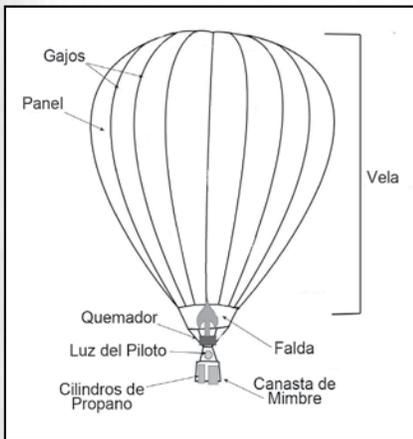
Diagrama de un globo de aire caliente
