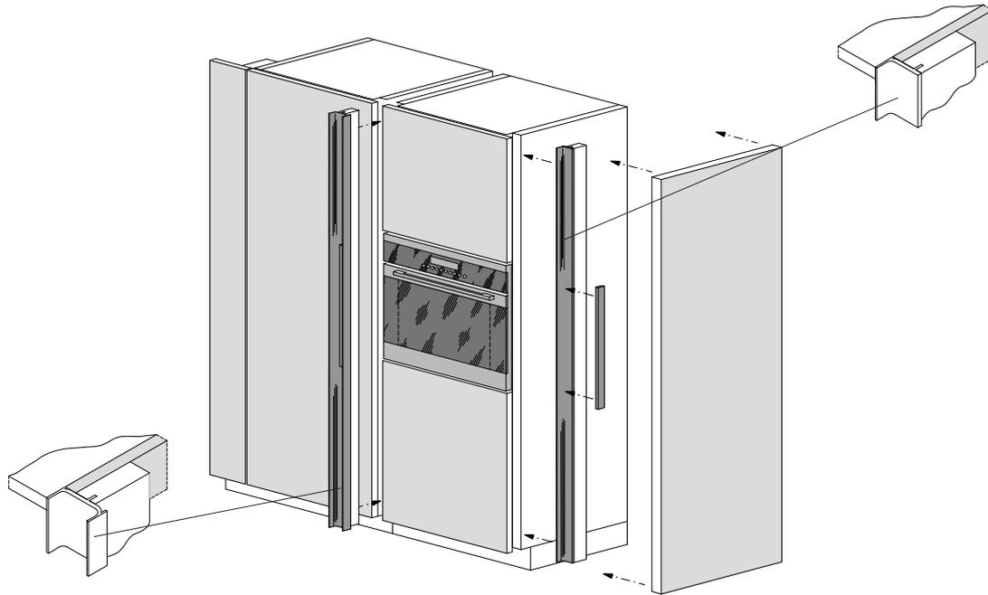
Die Griffmulden vertikal „Typ-L“ und „Typ-C“, werden vorne mit einer verleimten Montageleiste und hinten mit einer losen Distanzleiste ausgeliefert. Die Montageleiste wird bündig an der Korpusseite angeschraubt. Die Distanzleiste wird hinten angeschraubt, um mit dem darauf folgenden Hochschrank anzugrenzen und zu befestigen.
