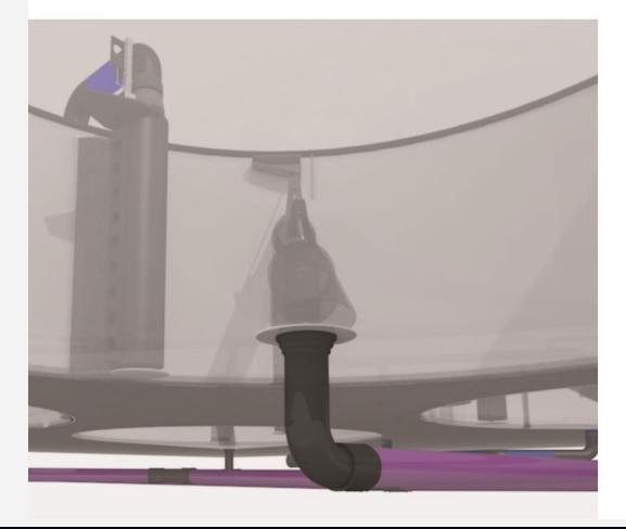
Fisketransportsluk er produktet for skånsom transport av fisk ut av karet. Sluken er produsert i polyetylen og er fri for skarpe kanter som fisken kan skade seg på. Fra sluken føres fisken direkte til transportsystemet plassert under karene.
