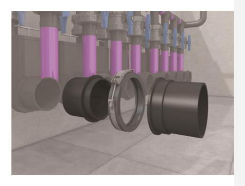
Ved fisketransport settes PS-koblingen på slangen som fører fisken dit den skal. Alle PS-koblingene har en lås av polyetylen, med klemme av rustfritt stål. Låsen er utformet med et spor på innsiden slik at den overlapper flensen på begge rørdelene.
