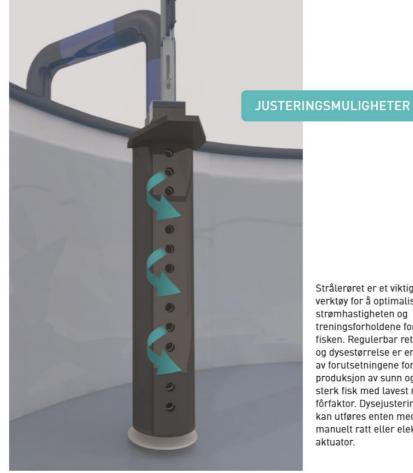
Strålerøret er et viktig verktøy for å optimalisere strømhastigheten og treningsforholdene for fisken. Regulerbar retning og dysestørrelse er en av forutsetningene for produksjon av sunn og sterk fisk med lavest mulig fôrfaktor. Dysejusteringen kan utføres enten med manuelt ratt eller elektrisk aktuator.
