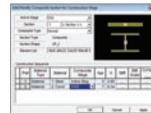
Sección compuesta para etapa constructiva para simular la acción compuesta con un elemento 1-D
