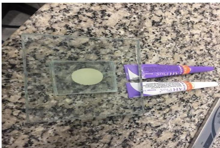
**Figura 1.** Disposição das placas de vidro e formação do halo de cimento onde foram obtidas as medidas do ensaio de escoamento.
