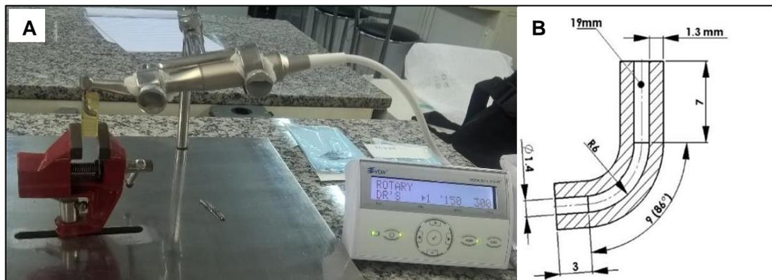
Figura 8. Aparato para ensaio de flexão rotativa: posicionamento do contra ângulo do motor elétrico e do canal artificial no aparato utilizado (A); ilustração do canal (B)
