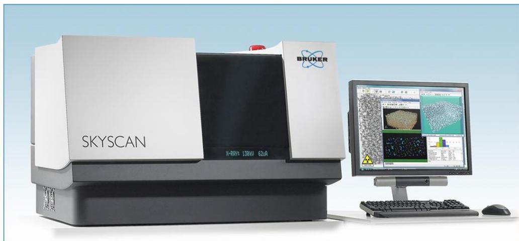
**Figura 1.** Micro-tomógrafo computadorizado (SkyScan 1173; Bruker-microCT, Bélgica).
