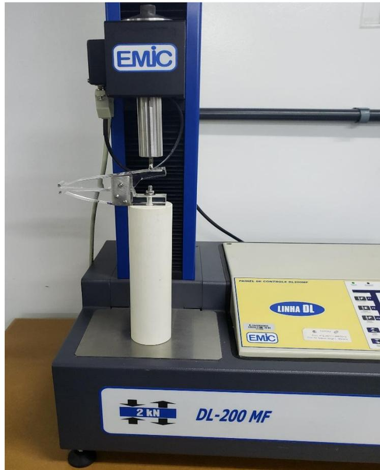
Figura 1. Dispositivo utilizado para mensuração da força de mordida.
