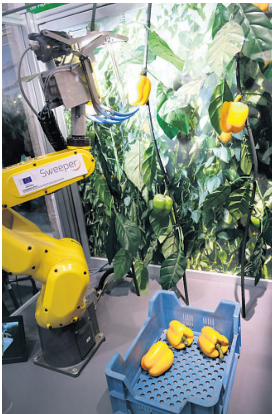
Wageningen University & Research werkt sinds tien jaar aan de Sweeper, een paprikaplukrobot. FOTO: GETTY
